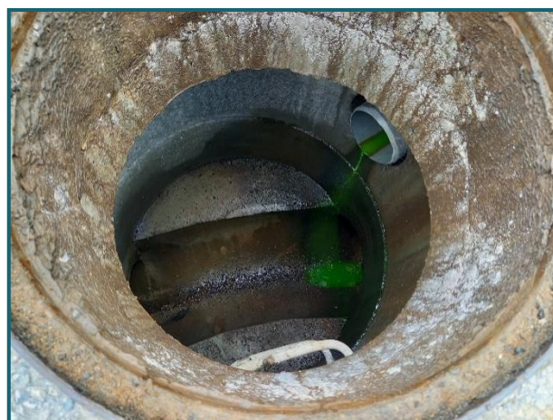
Eau teintée avec de la fluorescéine, utilisée pour repérer les branchements d'assainissement, particulièrement au niveau des regards d'assainissements
